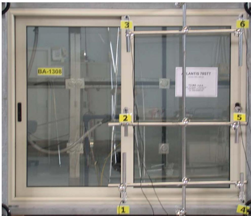
Foto 2: Campione sottoposto a prova durante i test di resistenza al vento (prova di deformazione)
